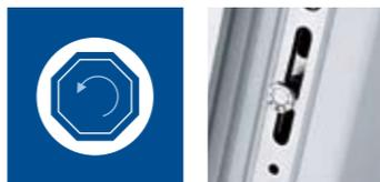
Изменения температуры влияют на расширение и усадку материала, из которого выполнено окно. Поэтому требуется периодическая регулировка прижима створки к раме. Восьмигранный запирающий грибок дает возможность простой регулировки прижима вручную. Поворачивая грибок, можно уменьшить прижим створки к раме летом и увеличить – зимой.
